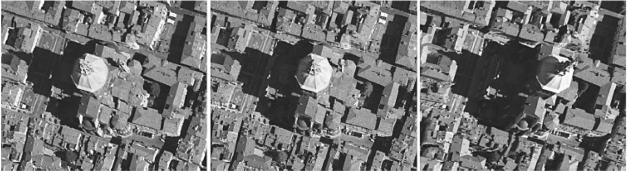
Figura 3: Visione triscopica fornita dai sensori backward , nadir e forward
